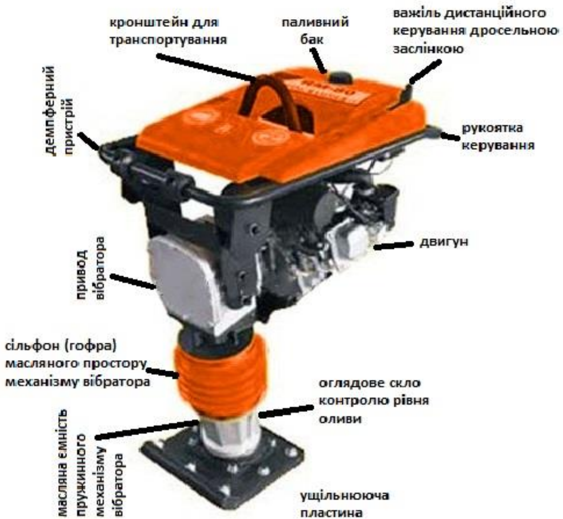
Мал. 1 Основні вузли вібротрамбовки
