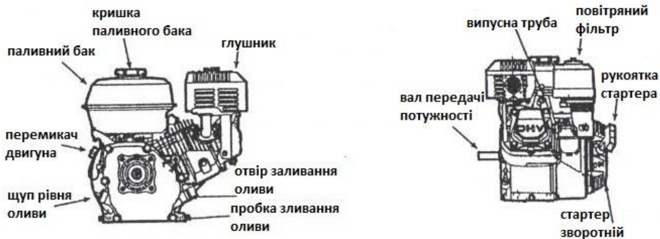
Мал. 2 Основні вузли двигуна машини затирочної
